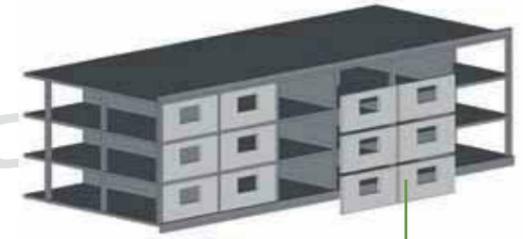
Panneaux de façade préfabriqués non structurels déposés
